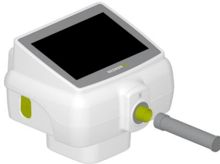
Figure 24 - Connexion de l'Objet de test à l'entrée du dispositif
