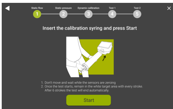
Abbildung 25 - Anweisungen für die Prüfung der Volumina für die langsame Spirometrie
