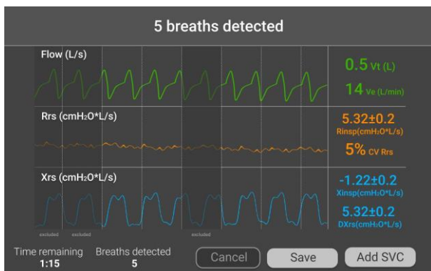
Abbildung 53 - Echtzeit-Kurven von Volumen und Impedanz
