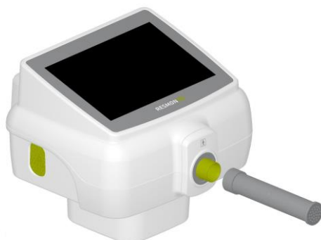
Abbildung 24 - Anschluss des Testobjekts an den Geräteeinlass
