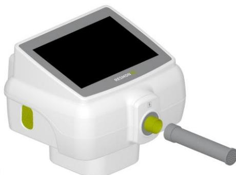
**Abbildung 24 - Anschluss des Testobjekts an den Geräteeinlass**
