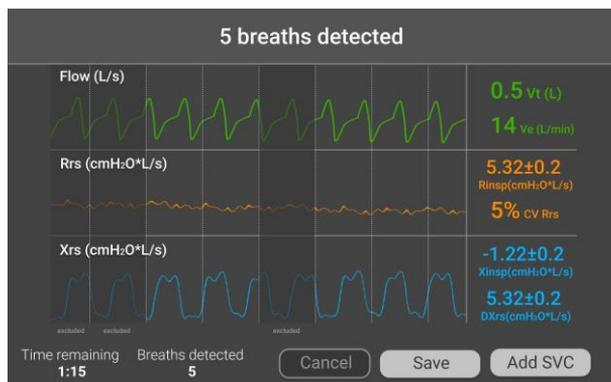
**Abbildung 53 - Echtzeit-Kurven von Volumen und Impedanz**
