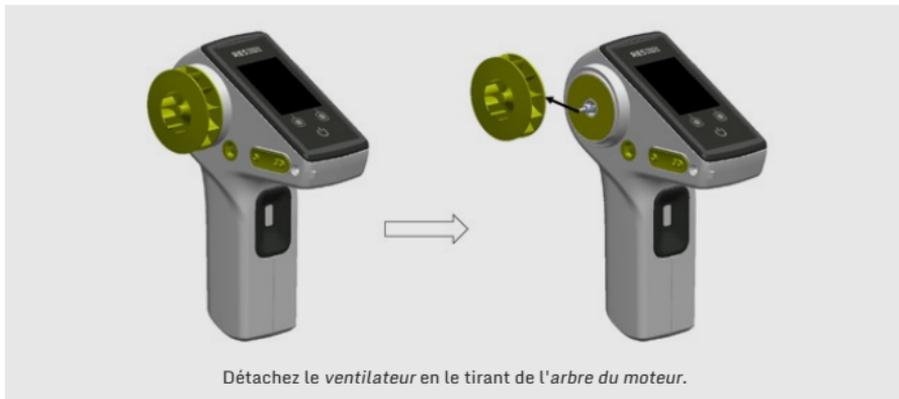
Pour **remonter l'appareil**, répétez les étapes précédentes dans l'ordre inverse, en veillant à maintenir le ventilateur parallèle au corps principal lors de sa réinsertion dans l'**arbre du moteur**.
