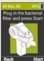
Schließen Sie den Filter an den Eingang des Atemkreislaufs an. Drücken Sie die Taste **Start** auf der rechten Seite, um die Messung des Filters zu starten, und warten Sie ein paar Sekunden.
