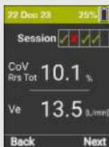
Gesamtzahl der durchgeführten Oszillometriemessungen, bis zu maximal fünf pro Sitzung; die für die Berechnung der Mittelwerte verwendeten Messungen sind mit einem grünen Häkchen gekennzeichnet, die verworfen mit einem roten Kreuz. Die **Qualitätskontrollparameter** der Messung (**Variationskoeffizient** zwischen den Messungen (CoV) der ausgewählten Messungen (grünes Häkchen) und die **mittlere Beatmung** (Ve) werden auf diesem Bildschirm angezeigt.
