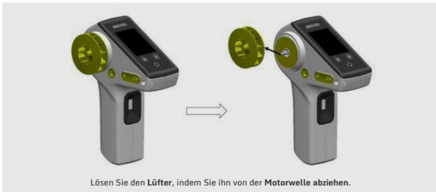
Lösen Sie den Lüfter, indem Sie ihn von der Motorwelle abziehen.
