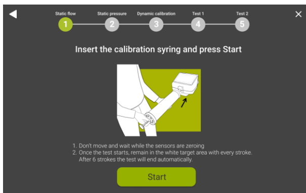
Figura 22 - Istruzioni per la verifica dei volumi di spirometria lenta
